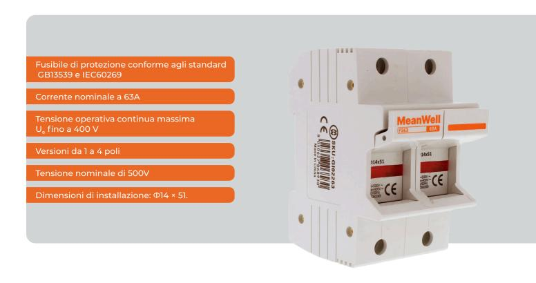
I portafusibili della serie FS63 sono dispositivi di protezione progettati per garantire la sicurezza dei circuiti in condizioni di sovracorrente. Realizzati con un design modulare e compatti, si installano facilmente su guida DIN da 35 mm. Compatibili con fusibili da  $\Phi$ 14×51, offrono protezione efficace fino a una tensione nominale di 500 V e una corrente nominale di 63 A, rendendoli ideali per applicazioni commerciali e industriali.
